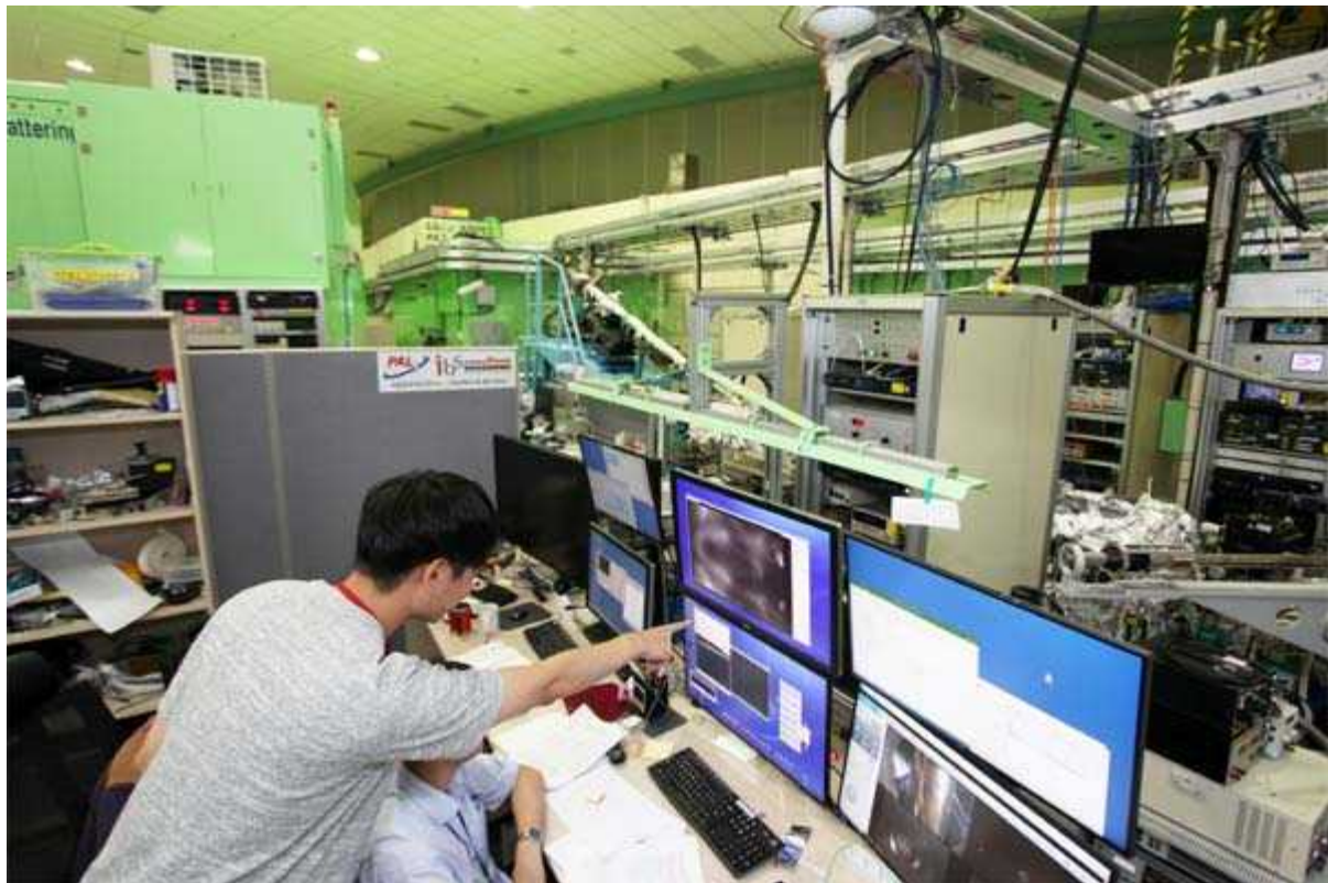
△포항 방사광가속기 내에 설치된 EUV용 PR 테스트 실험 장치. [사진 제공 = 포항가속기연구소]
